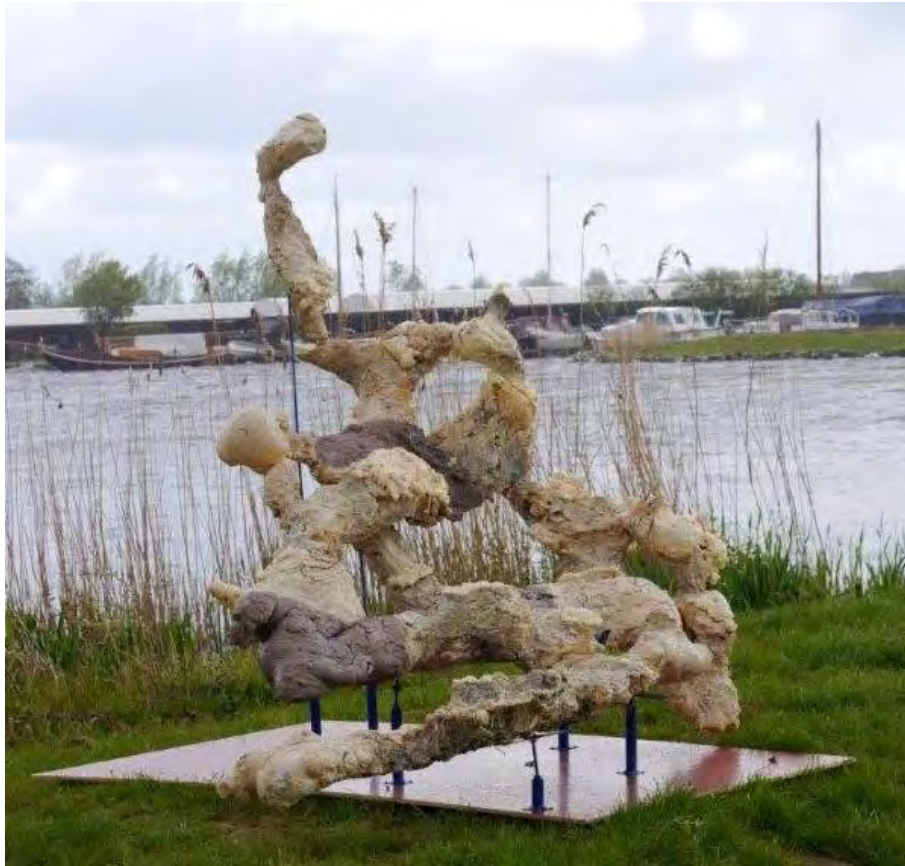
Foto 7. Een uit PUR-schuim opgebouwd model van een muskusratten burcht. In totaal zijn in opdracht van de STOWA circa vijf van dergelijke modellen gemaakt om de omvang van de burchten, de nestkommen en de pijpen te kunnen meten (Akkermans 2014). De waargenomen diameter van de pijpen was ca. 15-25 cm, de nestkommen hadden een diameter van 0.5 m en de pijpen gingen anderhalf tot zes meter de kant in (Foto: D. Moerkens, UvW).
